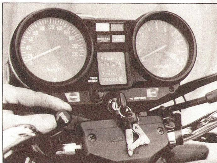
*Il dito indica il comodo tirante per lo starter di avviamento. Agevolmente raggiungibili anche i fusibili dell'impianto elettrico. Gli strumenti di bordo sono ben leggibili in ogni condizione e piuttosto precisi. Il tachimetro sovrastima del 6% la velocità reale.*
